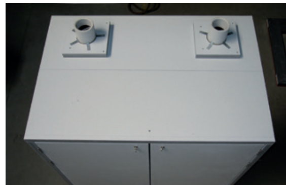
Be- und Entlüftungsanschlüsse
